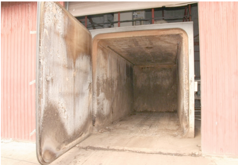
Fig. 3. Interior of the Herhof bioreactor (KLIMAS 2014)
